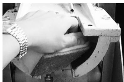
Вымойте тщательно измерительную камеру губкой и теплой водой. Если остались прилипшие остатки теста, удалите их скребком. Вытрите камеру насухо бумагой хорошо впитывающую влагу. мажьте поршень и тщательно установите его в камере. Установите сергу назад. Очистите сборочный поддон, смотри страницу 13.
