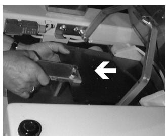
Проверьте шесть отверстий для смазки ножа, чтобы они были чистыми, без остатков теста.
