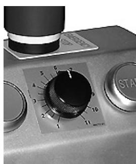
Регулировка скорости машины
