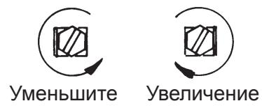
Снимите пластиковую крышку и с помощью отвертки подрегулируйте регулировочные винты. Чтобы увеличить количество масла, поверните винт по часовой стрелке, чтобы уменьшить количество поступающего масла, поверните против часовой стрелки.
