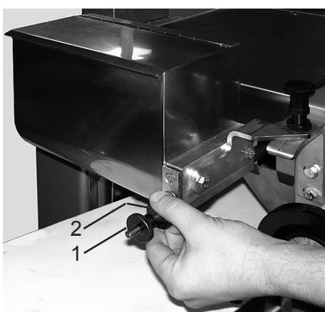
Доза определяется положением дозировочного винта.
