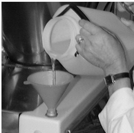
Машина тестируется на заводе-производителе на масле, адаптированном для хранения машины. Таким образом защищаются важные части
